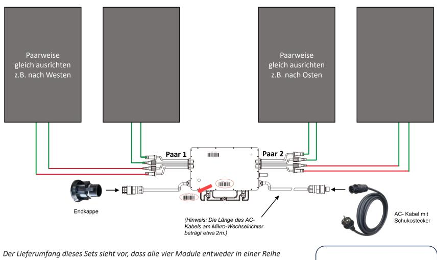
Der Lieferumfang dieses Sets sieht vor, dass alle vier Module entweder in einer Reihe oder als Insel (2 über 2) installiert werden. Zwei Module werden direkt durch moduleigene Kabel mit dem Wechselrichter verbunden und die übrigen durch die mitgelieferten Verlängerungen. Falls Sie eine andere Anordnung beabsichtigen, sind ggf. zusätzliche Verlängerungskabel notwendig.
